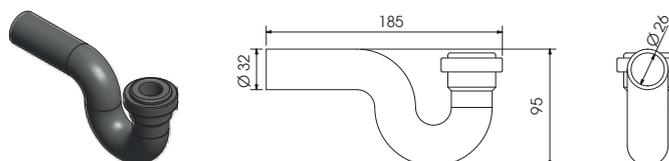
ANM.: 1 zusätzlichen Siphon vorsehen, wenn die Kaltwasserbatterie BA-AF/AC oder Gas DX vorgesehen ist, die 2 Kondensatabflüsse müssen alle mit einem Siphon versehen sein.
