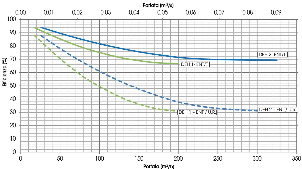
T = temperatura, recupero del calore sensibile / U.R. = umidità, recupero del calore latente
