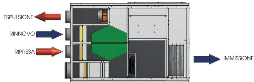
In caso non sia necessario attivare la deumidifica, l'unità funziona come una normale VMC ad alta efficienza; i costi di esercizio possono essere ottimizzati gestendo la macchina con fasce orarie (di serie, no controllo Easy), oppure in abbinamento a sonda di qualità aria CO<sub>2</sub> o CO<sub>2</sub>/VOC (opzionale).
