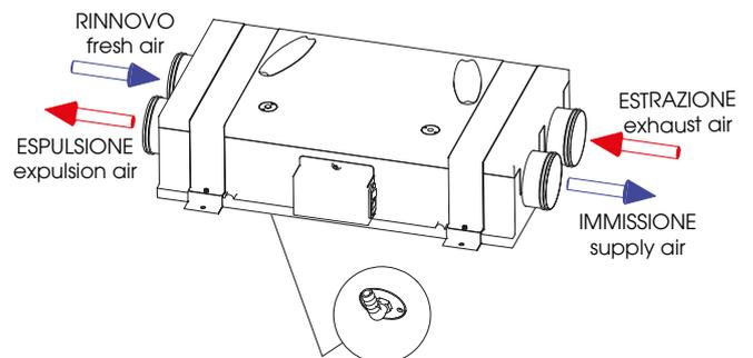
Lo scarico condensa va montato in prossimità dell'ESPULSIONE | The condensate drain must be mounted near the EXPULSION
