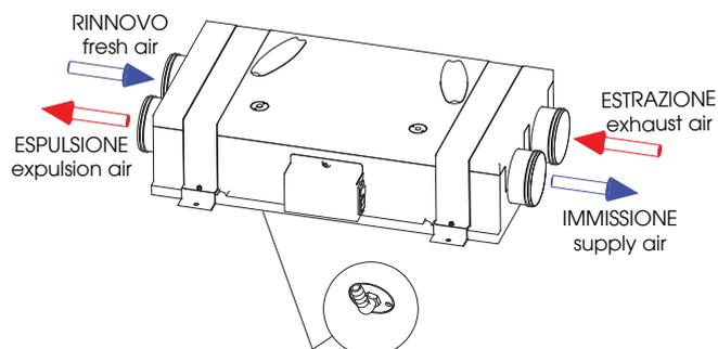
Lo scarico condensa va montato in prossimità dell'ESPULSIONE | The condensate drain must be mounted near the EXPULSION
