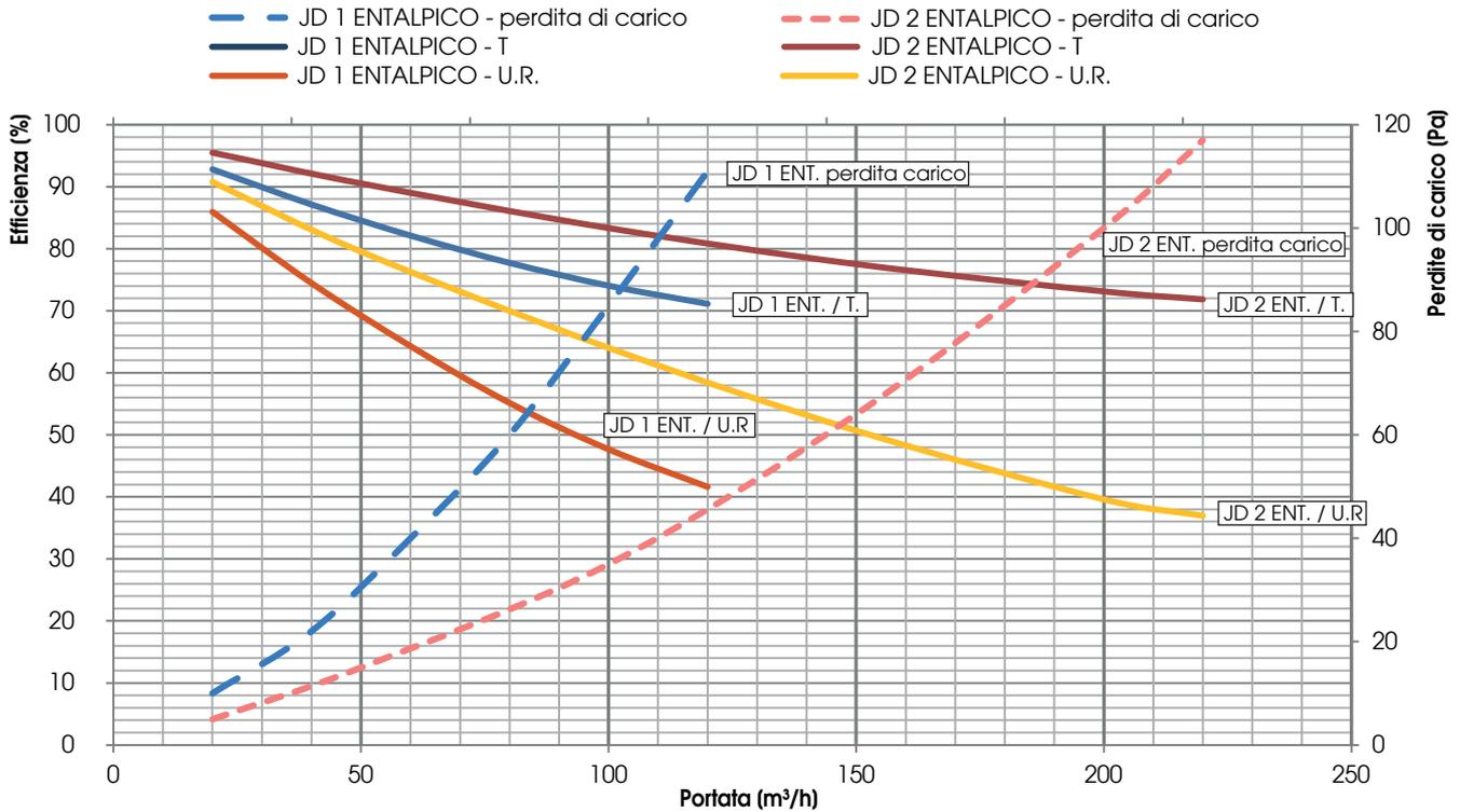
T = temperatura, recupero calore del sensibile / U.R. = umidità, recupero del calore latente
