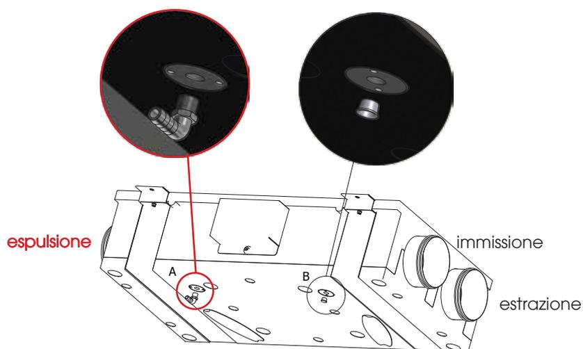
Lo scarico condensa va montato in prossimità dell'ESPULSIONE; N.B. - prevedere sifone sul circuito di scarico condensa
