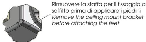
Rimuovere la staffa per il fissaggio a soffitto prima di applicare i piedini
