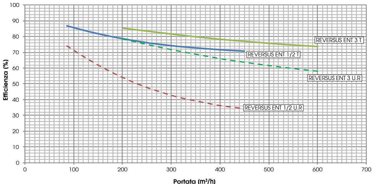
T = temperatura, recupero del calore sensibile / U.R. = umidità, recupero del calore latente
