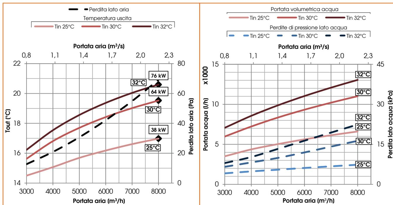
Batteria a GAS R410A - modulo singolo esterno
