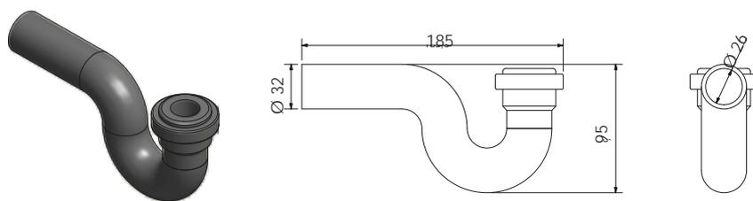
N.B.: prevedere 1 sifone addizionale se è prevista la batteria ad acqua fredda BA-AF/AC o gas DX (a canale)
