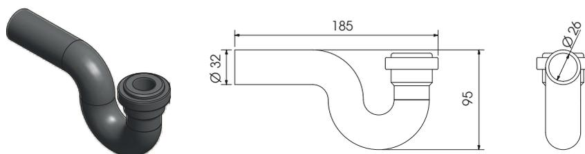
N.B.: prevedere 1 sifone addizionale se è prevista la batteria ad acqua fredda BA-AF/AC o gas DX (a canale)
