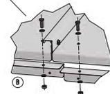
**B** Fissare il tetto ai supporti laterali usando bulloni, rondelle e dadi in dotazione
