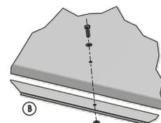
**B** Fissare il tetto ai supporti laterali usando bulloni, rondelle e dadi in dotazione
