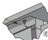
**C** Fissare i supporti laterali alla struttura in alluminio con le viti in dotazione
