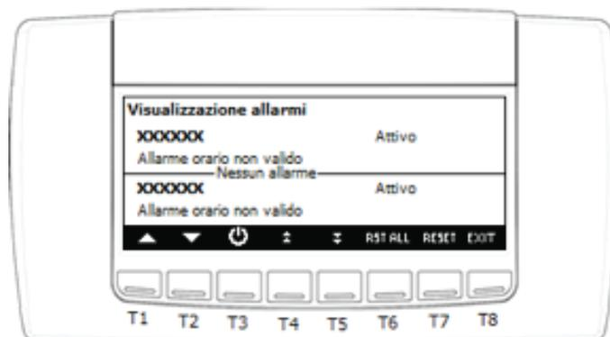
Dalla visualizzazione principale premendo il tasto **ALARM** è possibile accedere alla visualizzazione degli allarmi in corso; lo stato dell'allarme può essere:
