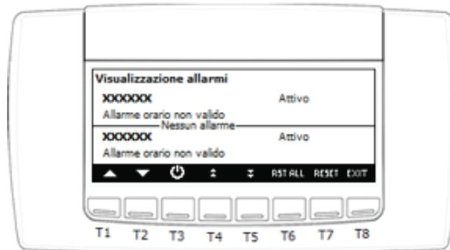
Tramite i tasti o è possibile visualizzare tutti gli allarmi in corso; lo stato dell'allarme può essere:
