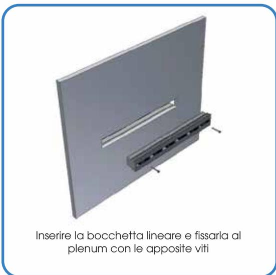
Inserire la bocchetta lineare e fissarla al plenum con le apposite viti
