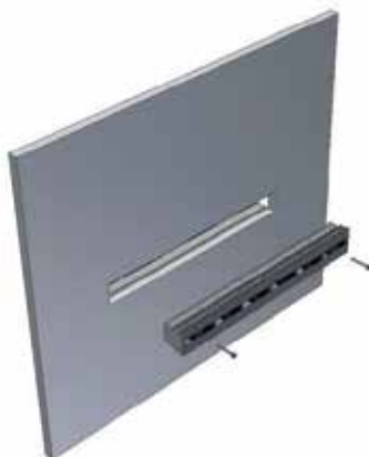
Die lineare Mündung einsetzen und am Plenum mit den betreffenden Schrauben befestigen
