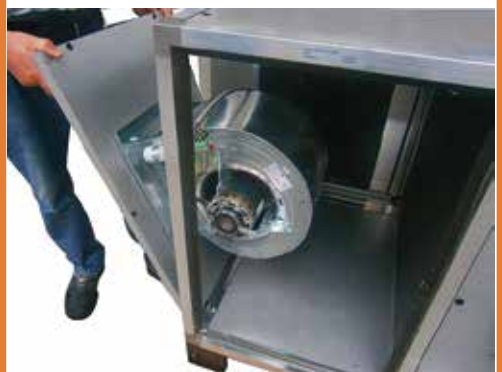
Inverser les 2 panneaux et brancher les fils du ventilateur
