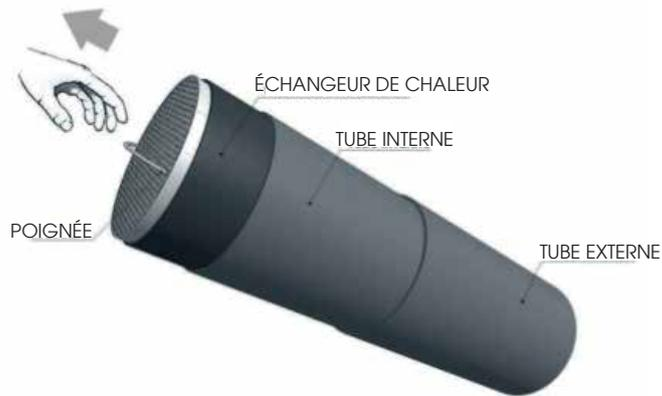
Couvrir le trou réalisé avec du mortier de ciment ou de la mousse polyuréthane ; introduire le tube télescopique à l'intérieur du trou réalisé, amener la partie du tube avec diamètre supérieur à ras de la paroi externe. Déplacer la partie du tube avec diamètre inférieur et l'amener à ras de la paroi interne.
