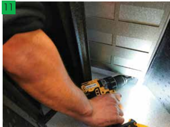
Rimuovere la vite inferiore sul fondo | Remove the bottom screw on the bottom
