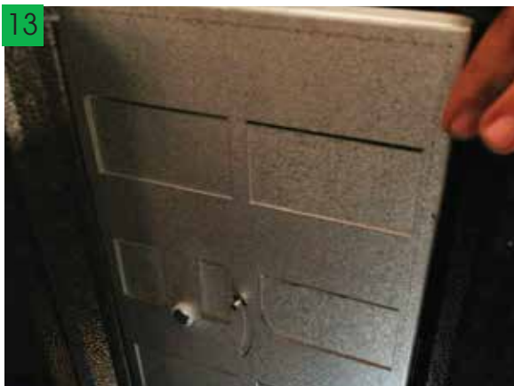
13 Posizionare il nuovo corpo by-pass da 230 V | Position the new 230 V by-pass
