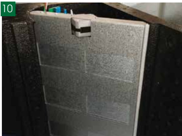
Posizionare il by-pass come illustrato in figura agendo manualmente sulla vite di comando in modo da scoprire la vite inferiore sul fondo | Position the by-pass as shown in the figure by turning the control screw manually so as to reveal the lower screw on the bottom
