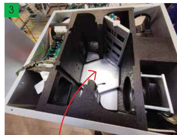
3 Togliere il pacco di scambio | Remove the heat exchanger
