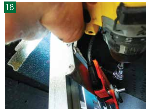
18 Avvitare la vite superiore e rimuovere la calamita dal motore | Screw in the top screw and remove the magnet from the motor
