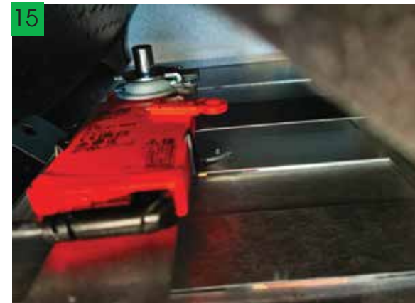
15 Posizionare la calamita sul motore per sbloccarne la rotazione come indicato in figura | Place the magnet on the motor to unlock its rotation as shown in the figure
