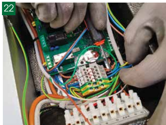
Ripristinare la connessione elettrica lato macchina e fissare il connettore al supporto | Restore the electrical connection on the machine side and fix the connector to the support
