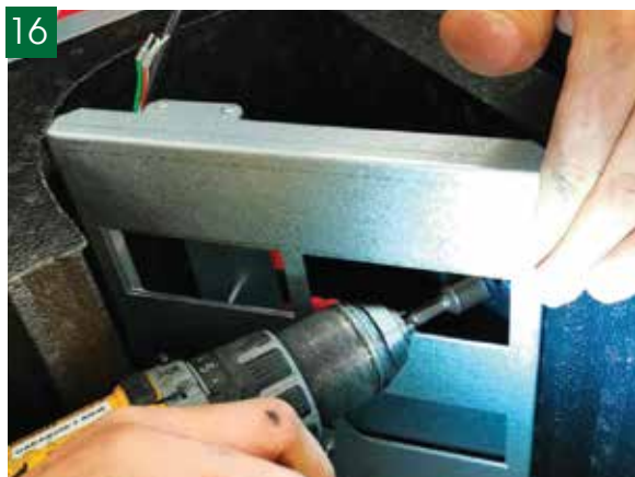
16 Avvitare la vite inferiore lato ispezione | Tighten the lower screw on the inspection side
