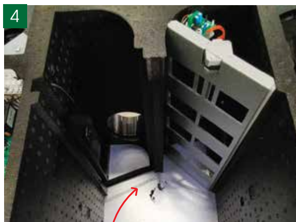
4 Estrarre la lamiera presente dietro il pacco di scambio | Extract the sheet present behind the heat exchanger
