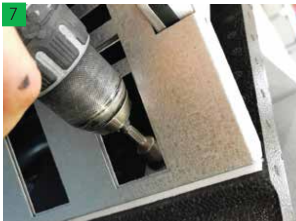
Rimuovere la vite inferiore lato ispezione del by-pass dopo averlo posizionato come indicato in figura agendo manualmente sulla vite di comando | Remove the lower screw on the inspection side of the by-pass after having positioned it as shown in the figure by turning the control screw manually
