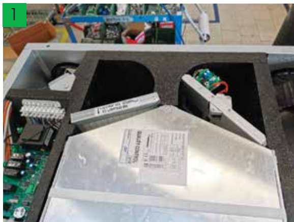
1 Aprire la macchina togliendo il pannello frontale | Open the unit by removing the front panel
