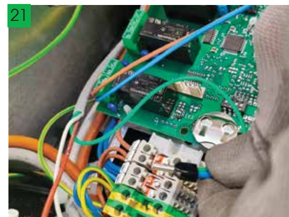
Collegare il cavo verde con il blu ad un morsetto N | Connect the green wire with blue to a terminal N
