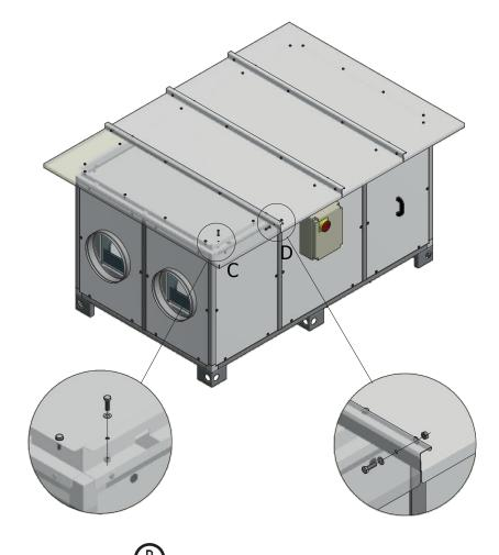
Assemblare tra di loro le falde del tetto come indicato in figura. Fissare il tetto alla flangia di sostegno laterale con le viti e le rondelle a tenuta in dotazione
