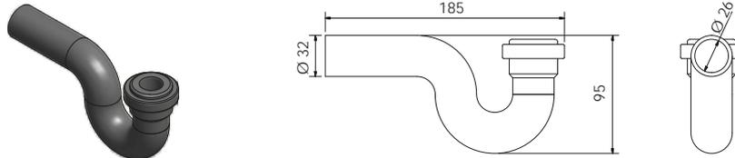
**N.B.:** prevedere 1 sifone addizionale se è prevista la batteria ad acqua fredda BA-AF/AC o gas DX; i 2 scarichi condensa devono avere ciascuno il proprio sifone. I sifoni sono fissati all'interno per proteggerli durante la spedizione / movimentazione
