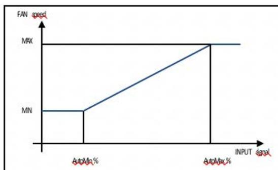
**AutoMin%** corrisponde al valore percentuale del segnale d'ingresso per cui i ventilatori devono funzionare alla minima velocità, **AutoMax%** corrisponde al valore percentuale del segnale d'ingresso per cui i ventilatori devono funzionare alla massima velocità. Per unità dotata di ventilatori a tre velocità
