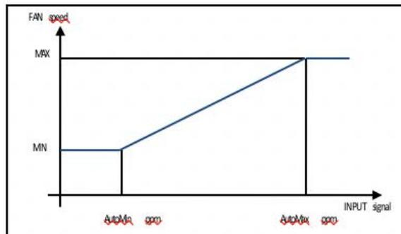
**AutoMin ppm** corrisponde alla concentrazione di CO2 (CO2-VOC) per cui si considera la qualità dell'aria ottima, **AutoMax ppm** corrisponde alla concentrazione di CO2 (CO2-VOC) per cui si considera la qualità dell'aria pessima.
