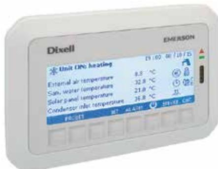
Le panneau de commande des groupes est un clavier graphique avec une résolution de l'écran de 82x156 mm et protection frontale IP65. Il est fourni aussi comme accessoire et peut être utilisé à distance jusqu'à 150 m du processeur du groupe.
