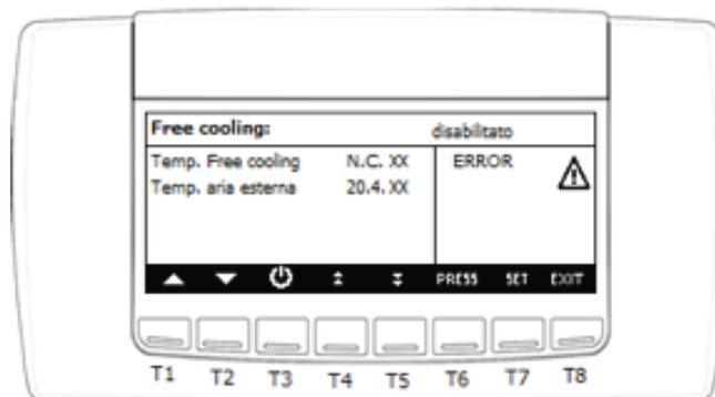
Le masque permet de sélectionner les paramètres relatifs au fonctionnement du free-cooling.
