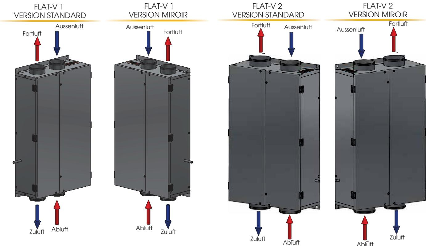
**HINWEIS:** FLAT-V 1 STANDARD, der Kondensatablauf befindet sich auf der linken Seite des Geräts. FLACH V 2 STANDARD Der Kondensatablauf befindet sich auf der rechten Seite des Geräts
