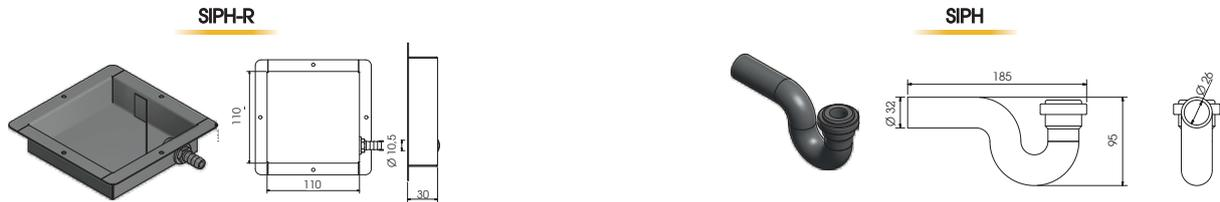
REMARQUES: prévoir 1 siphon supplémentaire en cas de batterie eau froide BA-AF / AC ou batterie gaz DX; les deux purgeurs de condensats doivent avoir chacun leur propre siphon
