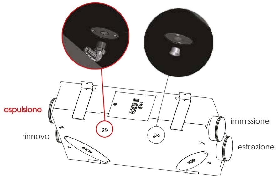
Lo scarico condensa va montato in prossimità dell'ESPULSIONE; prevedere sifone sul circuito di scarico condensa
